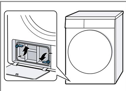
3. Die Wärmetauscherabdeckung am Griff herausziehen.
