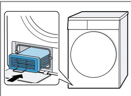
Stellen Sie sicher, den Wärmetauscher mit dem Griff nach unten zeigend einzuschieben.
