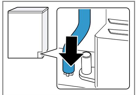
3. Den Wasserablaufschlauch bis zum Anschlag auf den Stutzen schieben.
