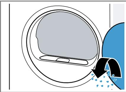
3. Das Flusensieb entfernen.
