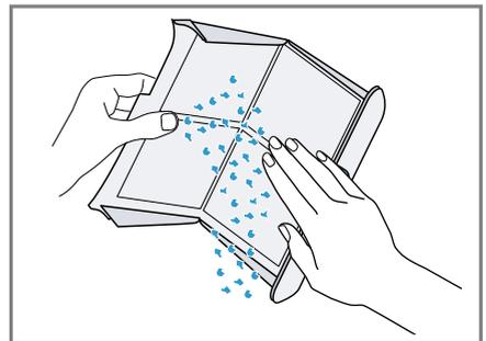
7. Das Flusensieb gründlich mit fließendem, warmem Wasser reinigen und abtrocknen.
