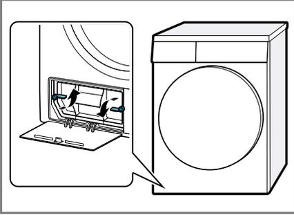
3. Tirar de la cubierta del intercambiador térmico por el asa.
