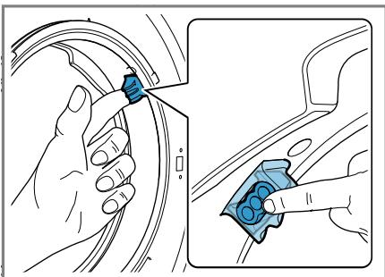
4. Pulire l'interno e l'esterno della manichetta di gomma con un panno inumidito e asciugare.
