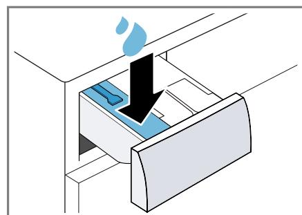
6. Pulvervollwaschmittel mit Sauerstoffbleiche in die Kammer für manuelle Dosierung einfüllen.
