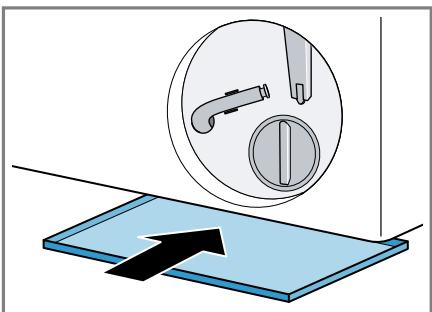
6. Den Entleerungsschlauch aus der Halterung nehmen.
