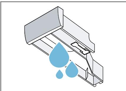
7. Die Pumpeneinheit mit einem feuchten Tuch reinigen.
