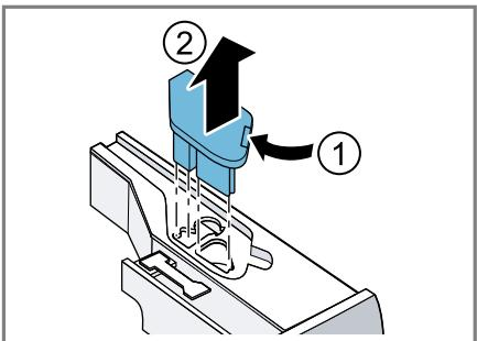
5. Den Deckel der Waschmittelschublade entrostern und entfernen.
