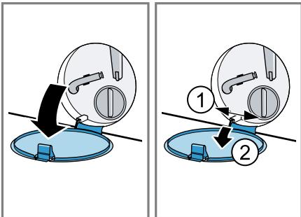
5. Ein passendes Gefäß zum Ablösen der Waschlauge unter die Öffnung schieben.
