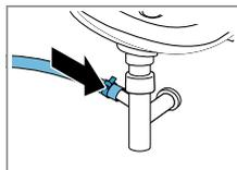
Fixez le point de raccordement avec un collier de serrage (24-40 mm).
