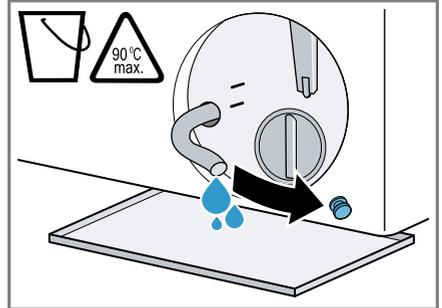
8. Appuyez sur le bouchon de fermeture.
