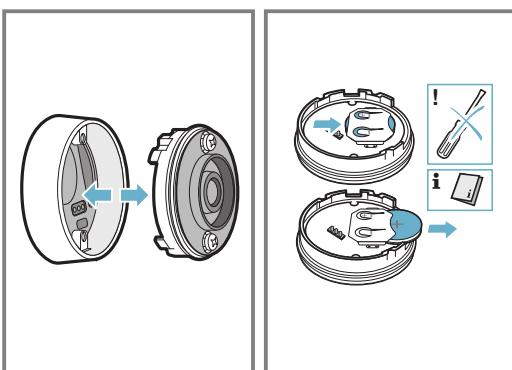
3. 裝入新的電池，同時請按照電池極的指示操作。僅限使用CR2032類型的高品質電池。
