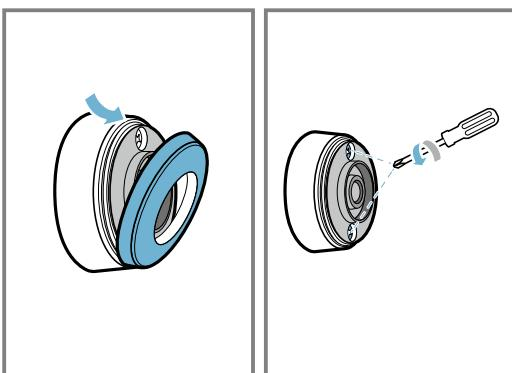
2. 打開溫控感應器蓋，將電池從底座取出。
