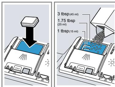
Si des pastilles sont utilisées, une seule suffit. Disposer la pastille horizontalement. Si vous utilisez du détergent en poudre ou liquide, observez les indications de dosage du fabricant et la graduation du dosage du compartiment à détergent.
