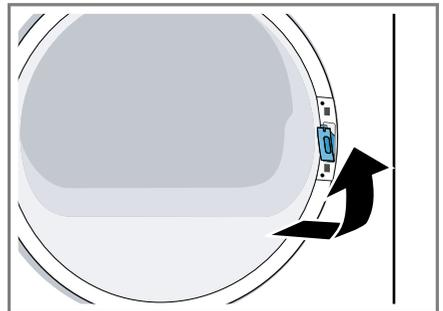
4. Die Abdeckung der Türverriegelung anschrauben.
