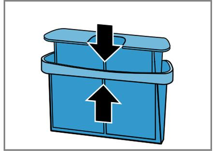
10. Das zweiteilige Flusensieb einsetzen.
