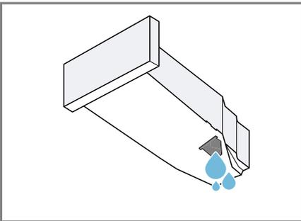
Prüfen Sie regelmäßig den Filter des Kondenswasserbehälters → *Seite 45* und reinigen Sie einen verunreinigten Filter. Stellen Sie sicher, den Kondenswasserbehälter vor dem Betrieb des Geräts einzuschieben.
