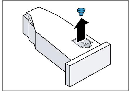
2. Den Stöpsel an der Unterseite einsetzen.
