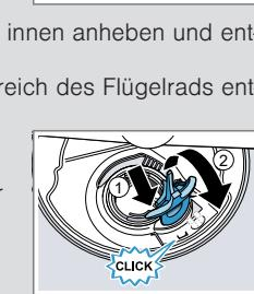
5. Die Pumpenabdeckung schräg nach innen anheben und entnehmen.
