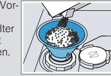
3. Das Spezialsalz in den Vorratsbehälter füllen. Das Wasser im Vorratsbehälter wird verdrängt und läuft ab. Nie Reiniger einfüllen.
