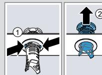
5. Unter fließendem Wasser die Siebelemente reinigen.
