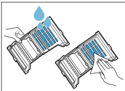
Odolné nečistoty môžete opatrne odstrániť mäkkou kefkou. Tesnenie vložky na vlákna nesmiete poškodiť ani odstrániť. Vložku na vlákna môžete čistiť v umývačke riadu.
