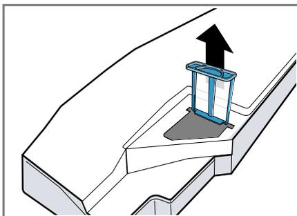
3. Vyčistite filter pod teplou tečúcou
