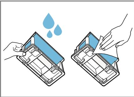
Sie können starke Verunreinigungen vorsichtig mit einer weichen Bürste entfernen. Stellen Sie sicher, das Sieb gründlich abzutrocknen. Ein feuchtes Sieb kann die Trocknungszeit verlängern und das Trocknungsergebnis beeinflussen.
