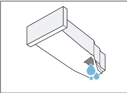
Prüfen Sie regelmäßig den Filter des Kondenswasserbehälters → *Seite 44* und reinigen Sie einen verunreinigten Filter. Stellen Sie sicher, den Kondenswasserbehälter vor dem Betrieb des Geräts einzuschieben. → *"Kondenswasserbehälter einschieben"*, *Seite 31*
