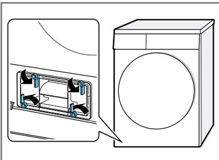
3. Die Wärmetauscherabdeckung am Griff herausziehen.
