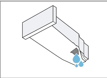
6. Den Kondenswasserbehälter bis zum Einrasten einschieben.
