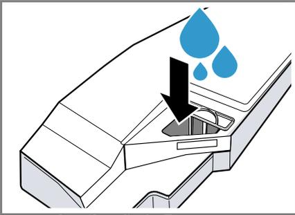
Halten Sie den gefüllten Kondenswasserbehälter waagrecht, damit keine Flüssigkeit ausläuft.
