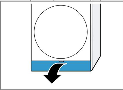
Wenn Sie ein Tuch unter die Wartungsklappe legen, können Sie das Restwasser der Bodeneinheit auffangen.
