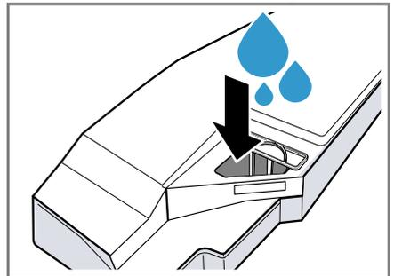
Halten Sie den gefüllten Kondenswasserbehälter waagrecht, damit keine Flüssigkeit ausläuft.
