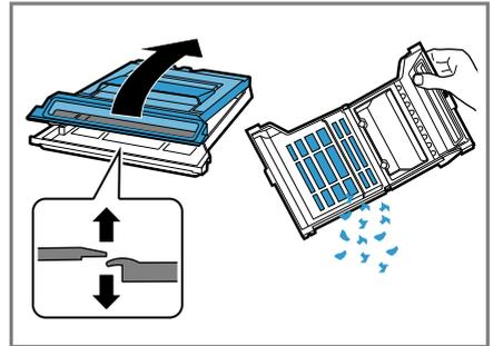
6. Das Sieb unter fließendem Wasser gründlich reinigen und abtrocknen.
