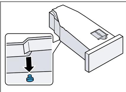
6. Den Stöpsel in die Mulde der Oberseite einsetzen.
