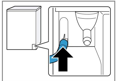
3. Den Wasserabflussschlauch bis zum Anschlag auf den Stutzen schieben.
