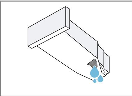
5. Den Stöpsel der Unterseite entfernen.
