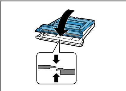
8. Das Flusendepot waagrecht bis zum Anschlag einschieben.
