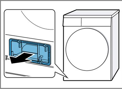
1. Die Wärmetauscherabdeckung am Griff einsetzen.
