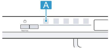
Se o LED A não se acender, a ligação à rede sem fios está desligada.
