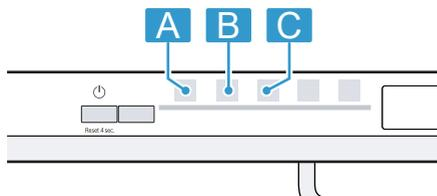
Se o LED A se acender, a função está desativada permanentemente. Se o LED A e o LED B se acenderem, a função pode ser selecionada através da tecla **Start**.
