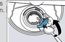
4. Die Pumpenabdeckung mit Hilfe eines Löffels aushebeln und am Steg fassen.
