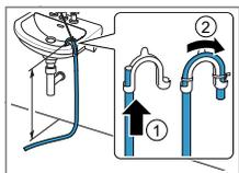
Poussez le tuyau d'évacuation d'eau complètement à travers le et fixez-le avec le matériel de fixation. Fixez le coude à une hauteur de 100 cm maximum.
