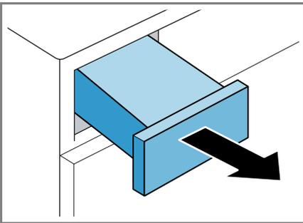
2. Vider le réservoir d'eau de condensation.
