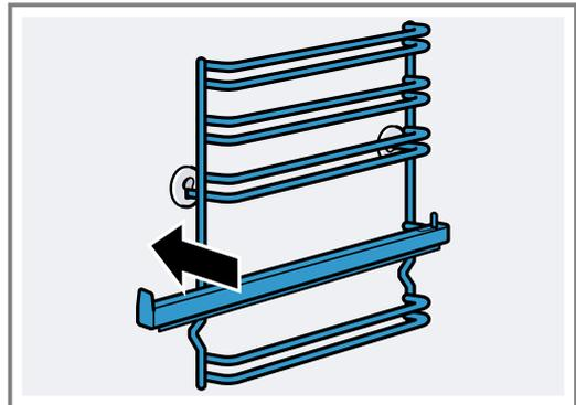
Die Gestelle passen rechts und links. Die Einschubhöhen 1 und 2 befinden sich unten, die Einschubhöhen 3, 4 und 5 oben. Die Auszugsschiene nach vorne herausziehen.
