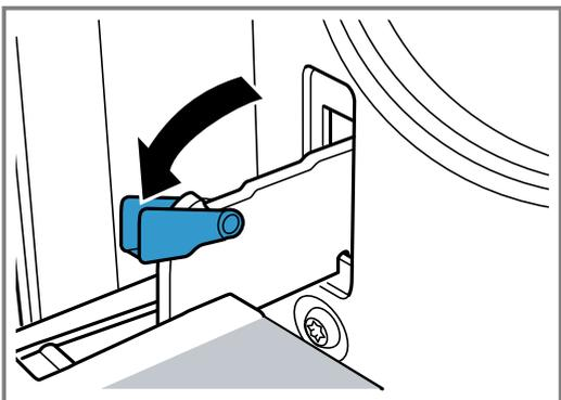
3. Die Backofentür bis Anschlag schließen. Mit beiden Händen links und rechts anfassen. Noch etwas weiter schließen und herausziehen.
