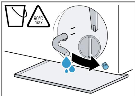
8. Appuyez sur le bouchon de fermeture.
