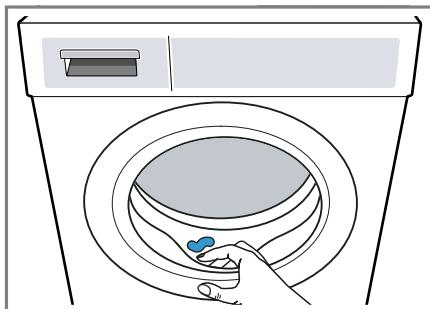
3. Laissez la porte de l'appareil et le bac à produits ouverts afin que l'eau résiduelle puisse s'évaporer.
