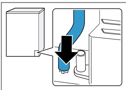
3. Insertar la manguera de desagüe hasta el tope en la boquilla.
