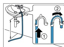
Deslizar la manguera de salida de agua completamente por el y fijarla con el material de fijación. Fijar el racor en codo a una altura máxima de 100 cm.
