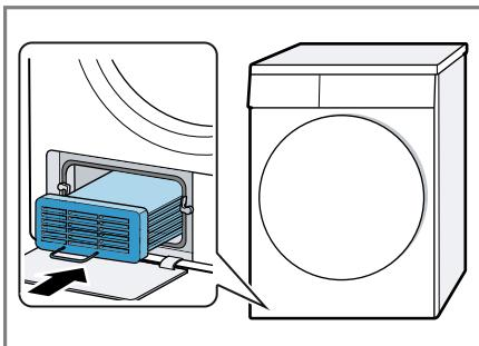
Asegurarse de insertar el intercambiador de calor con el asa hacia abajo.
