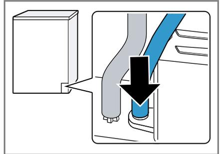
4. Insérez le tuyau d'évacuation d'eau dans le guide de flexible.
