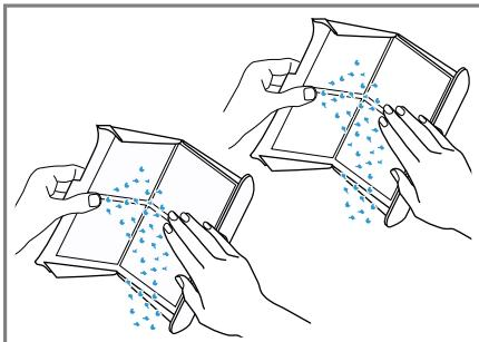
Eliminar las pelusas con la basura doméstica para evitar la contaminación del agua residual con microplásticos.
