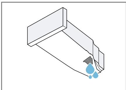
Comprobar regularmente el filtro del recipiente de agua condensada y limpiarlo si está sucio.
