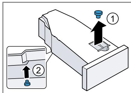
2. Limpiar el filtro del depósito de agua condensada.
