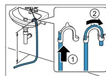
Deslizar la manguera de salida de agua completamente por el racor en codo y fijarla con el material de fijación. Fijar el racor en codo a una altura máxima de 100 cm.
