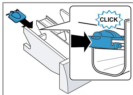
4. Die Waschmittelschublade einsetzen.
