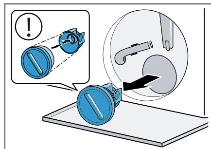
2. Očistite unutarnji prostor, navo na poklopcu crpke te kućište crpke.
