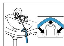
Odvodno crijevo za vodu fiksirajte koljenom i osigurajte ga.
