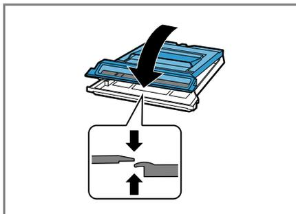
8. Insérez le dépôt de peluches à l'horizontale jusqu'en butée.
