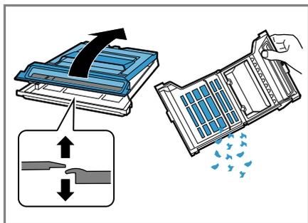
6. Nettoyez soigneusement le filtre sous l'eau courante et séchez-le.
