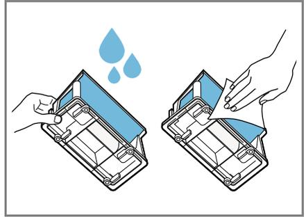
Vous pouvez retirer soigneusement les salissures importantes avec une brosse douce. Veillez à bien sécher le filtre. Un filtre humide peut rallonger la durée de séchage et influencer le résultat de séchage.
