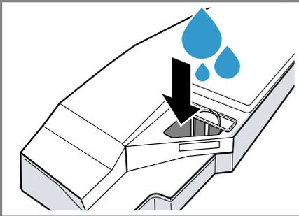
Maintenez toujours le réservoir d'eau de condensation rempli à l'horizontale pour qu'aucun liquide ne s'écoule.
