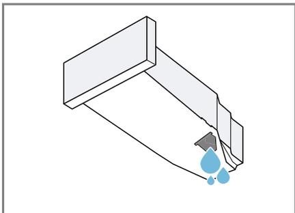
6. Enfoncez le réservoir d'eau de condensation jusqu'à ce qu'il s'enclenche.
