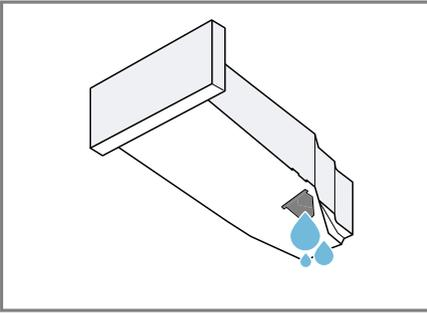
6. Enfoncez le réservoir d'eau de condensation jusqu'à ce qu'il s'enclenche.
