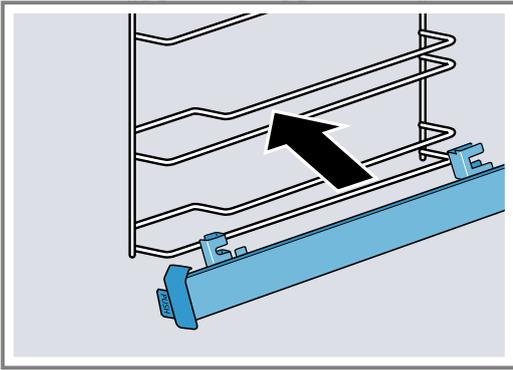
2. Introduisez la fixation [a] entre la barre inférieure et la barre supérieure.
