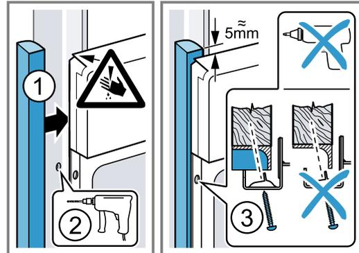
**Remarque :** L'écart entre le plan de travail et l'appareil ne peut pas être obturé par des baguettes supplémentaires. Aucune baguette de protection thermique ne doit être montée sur les parois latérales du meuble d'encastrement.
