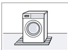
Instalar o aparelho sobre uma placa de madeira impermeabilizada (com 30 mm de espessura mínima) fixamente aparafusada ao chão.
