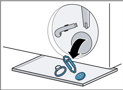
A tampa da bomba é composta por dois componentes que podem ser separados para efeitos de limpeza.
