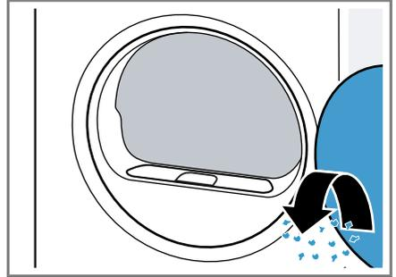
3. Das zweiteilige Flusensieb entfernen.
