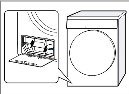
3. Die Wärmetauscherabdeckung am Griff herausziehen.
