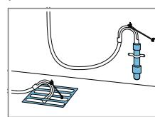
Fissare e assicurare il raccordo di scarico dell'acqua con un collettore → Pagina 29.
