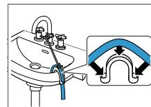
Fissare e assicurare il raccordo di scarico dell'acqua con un collettore → Pagina 29.
