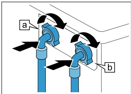
2. Collegare il tubo flessibile di carico per l'acqua calda **a** (rosso) e per l'acqua fredda **b** (blu) al rubinetto (26,4 mm = 3/4").
