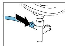
Fissare il punto di collegamento con una fascetta stringitubo (24-40 mm).
