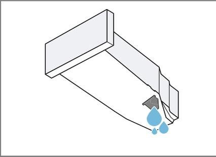
Kontroller filteret i kondensvannbeholderen → *Side 41* regelmessig og rengjør det når det er skittent.
