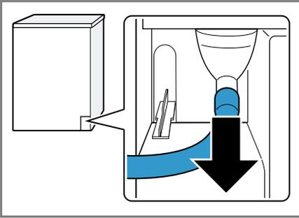
Kondensvannslangen er koblet til stussen fra fabrikk.
