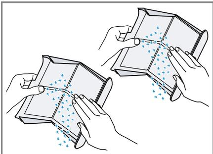
8. Vask de to lofiltrene grundig i rennende, varmt vann og tørk dem.
