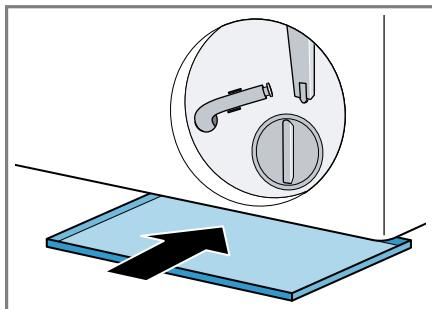
6. Den Entleerungsschlauch aus der Halterung nehmen.
