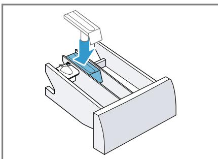
6. Die Öffnung für die Waschmittelschublade reinigen.
