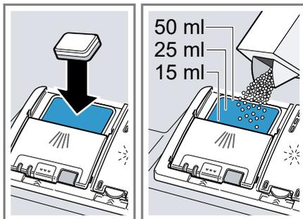
Se utilizar pastilhas, basta uma pastilha. Coloque a pastilha transversalmente.
