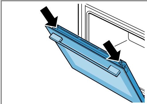
3. 將電器門完全打開，然後朝電器方向壓。
