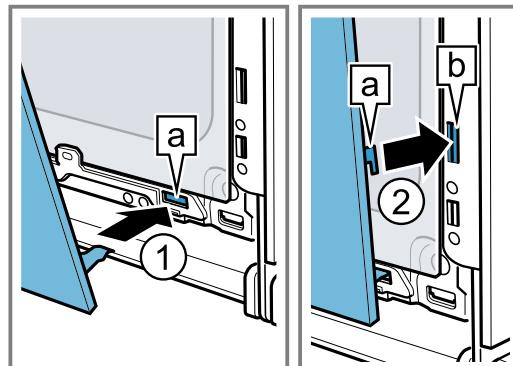
3. 緊壓前板玻璃下方①，直到聽見扣入的聲音。
