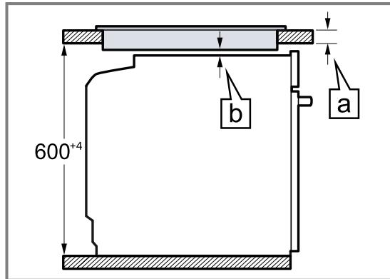
根據必要的最小間距 **a**，計算出工作檯面的最小厚度為**b**。
