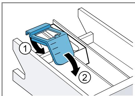
4. Die Waschmittelschublade einsetzen.
