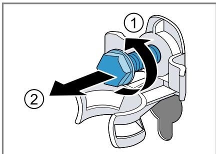
3. Die Netzanschlussleitung von der Halterung entfernen.
