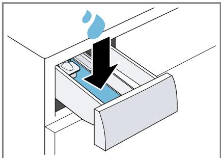
5. Pulvervollwaschmittel in die Kammer II einfüllen.
