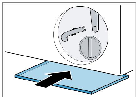
6. Den Entleerungsschlauch aus der Halterung nehmen.
