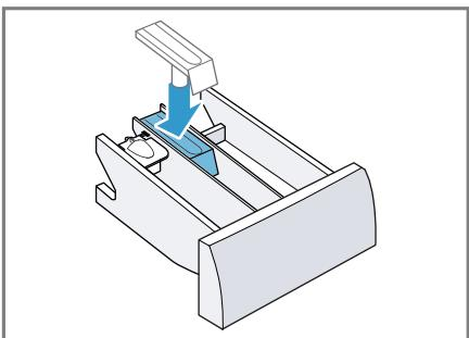
6. Die Öffnung für die Waschmittelschublade reinigen.
