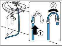
Poussez le tuyau d'évacuation d'eau complètement à travers le coude et fixez-le avec le matériel de fixation. Fixez le coude à une hauteur de 100 cm maximum.
