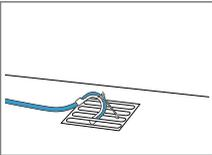
Poussez le tuyau d'évacuation d'eau complètement à travers le coude et fixez-le avec le matériel de fixation. Fixez le coude sur la bouche d'évacuation.
