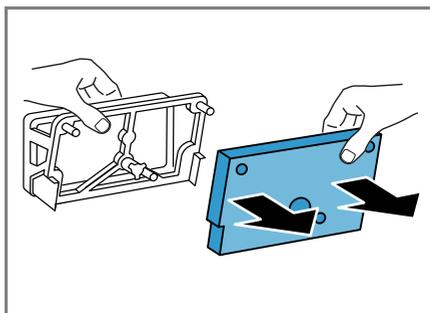
Veillez à ne pas déformer ni endommager le matelas filtrant.
