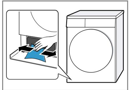
9. Insérez l'insert horizontalement jusqu'à ce que la patte s'enclenche.
