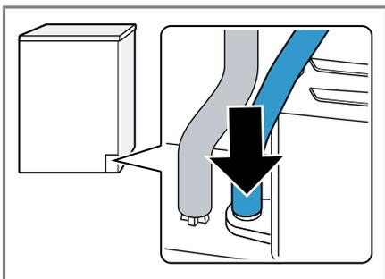
4. Insérez le tuyau d'évacuation d'eau dans le guide de flexible.
