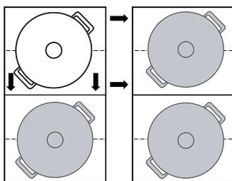
La stoviglia viene riconosciuta e sull'indicatore della nuova area di cottura lampeggiano in modo alternato il livello di potenza precedentemente selezionato e  $L$ .
