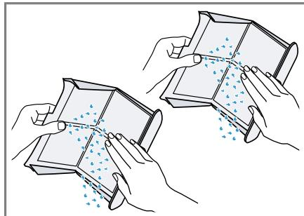
**8.** Ретельно промийте обидві фільтрувальні сітки під теплою проточною водою і висушіть їх.
