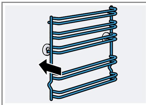
Les supports s'adaptent à droite et à gauche. Les niveaux d'enfournement 1 et 2 se trouvent en bas, les niveaux d'enfournement 3, 4 et 5 en haut.
