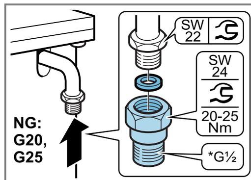
3. Posez le nouveau joint du flexible de gaz ou du tuyau flexible de sécurité de gaz. Veillez à ce que le joint soit correctement en place.
