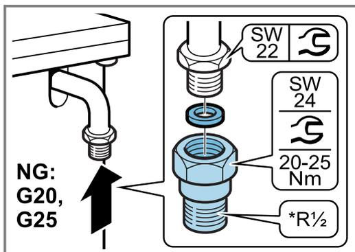
3. Fixez la pièce de raccordement avec une clé de 24 et posez le raccord fileté du flexible de gaz ou du tuyau flexible de sécurité de gaz avec une clé de 24 sur la connexion et serrez-le bien.
