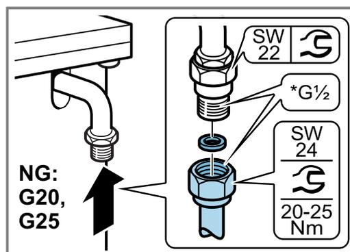
5. Ouvrez le dispositif de coupure du raccordement au gaz. Procédez à un test d'étanchéité → Page 44.
