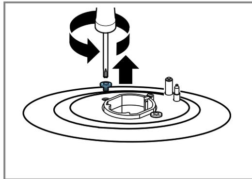
4. Retirez les deux vis (T20) du devant à droite et à gauche de la plaque de cuisson. Ne retirez pas les pièces en plastique se trouvant en dessous.
