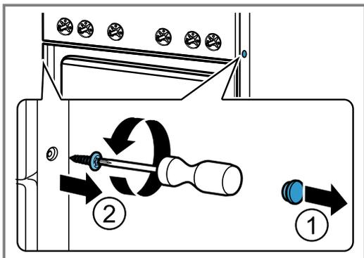
7. **Remarque :** Retirez les vis mentionnées ci-dessous afin de ne pas endommager l'interrupteur ni les parties électroniques.
