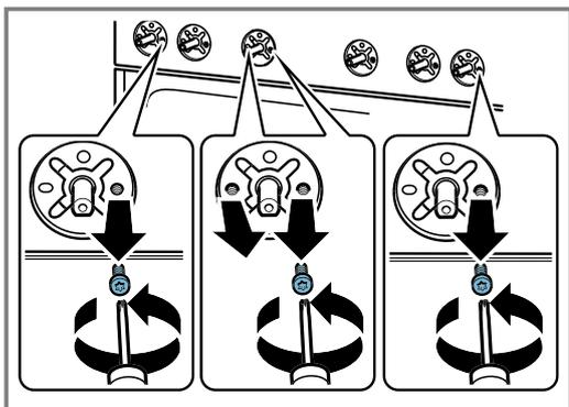
8. **Remarque :** Pour accéder aux buses de dérivation sur le côté droit, tournez légèrement le bandeau vers la droite. Pour accéder aux buses de dérivation sur le côté gauche, tournez légèrement le bandeau vers la gauche. Veillez à ne pas endommager les câbles et à ne pas desserrer les connexions.
