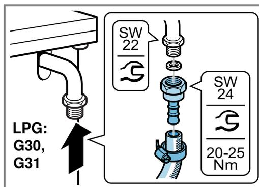
3. Enfichez le tuyau flexible de sécurité de gaz et serrez-le bien avec un raccord vissé ou un collier de serrage.
