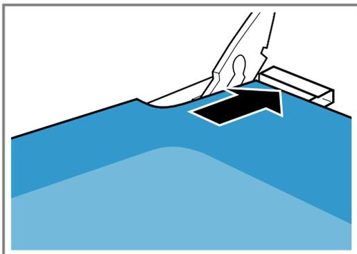
Insérez la vitre dans les deux ouvertures du bas. La face lisse de la vitre doit être à l'extérieur.
