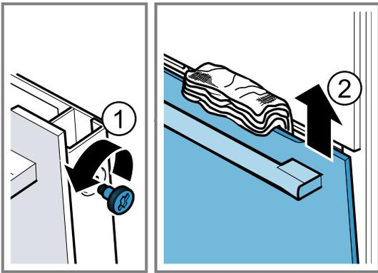
5. Tirer la vitre frontale avec la poignée de la porte vers le bas et la déposer sur une surface plane.
