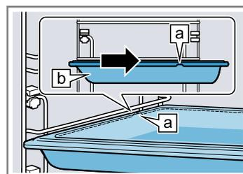
Posez l'accessoire sur les rails télescopiques insérés.
