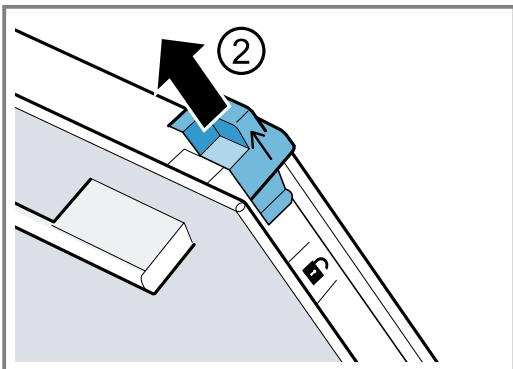
6. Izvucite unutarnje staklo koso prema gore i oprezno ga odložite na ravnu površinu.
