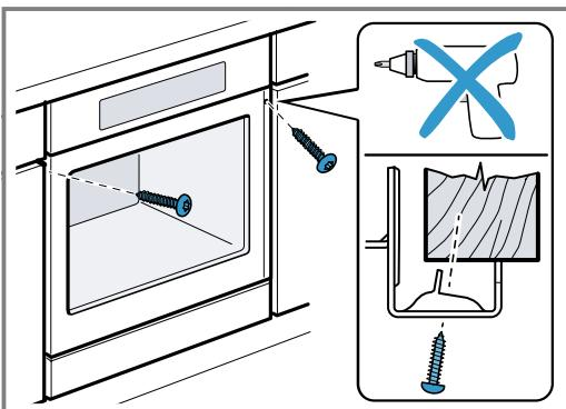
**Napomena:** Otvor između radne ploče i uređaja ne smije se zatvarati dodatnim letvicama.
