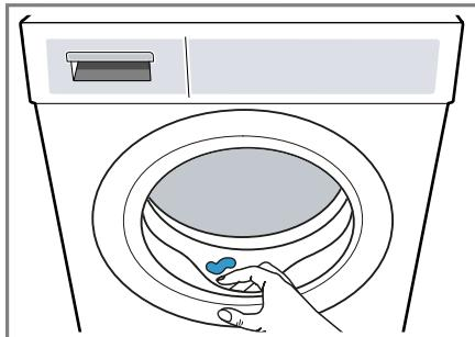
3. Die Gerätetür und die Waschmittelschublade offen lassen, damit Restwasser abtrocknen kann.
