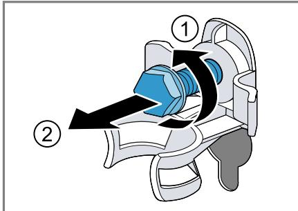
3. Die Netzanschlussleitung von der Halterung entfernen.
