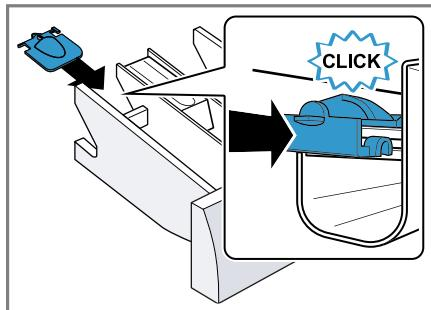
4. Die Waschmittelschublade einsetzen.
