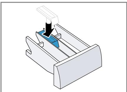
6. Die Öffnung für die Waschmittelschublade reinigen.
