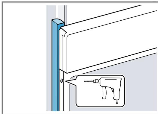
4. Das Gerät mit adäquater Schraube befestigen.
