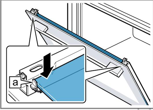
5. Die Gerätetür öffnen und Türdichtung einhängen.
