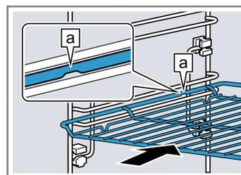
Blech Das Blech mit der Abschrägung
