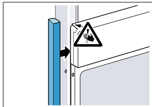
2. Aluprofile vorbohren, um eine Schraubverbindung herzustellen.
