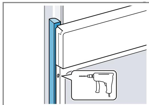
3. Gerät mit adäquater Schraube befestigen.
