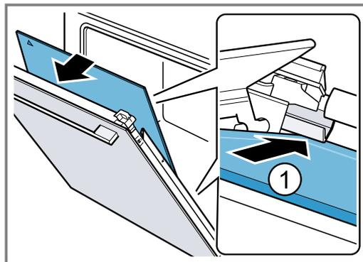
2. **Hinweis:** Die Zwischenscheibe positioniert sich automatisch durch die Drehbewegung der Abstandshalterung.
