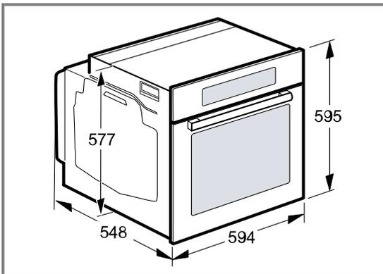
**30.3 Einbau unter einer Arbeitsplatte**
