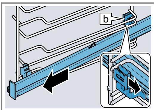
4. Die Auszugsschiene entfernen.
