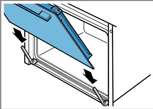
2. Mit beiden Händen die Gerätetür bis zum Anschlag schieben.
