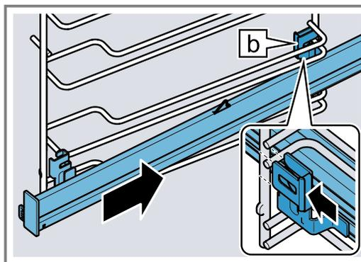
3. **PUSH** gedrückt halten ① und die Auszugsschiene nach innen schwenken ②, bis die Halterung [a] in den unteren Stab eingehängt ist.
