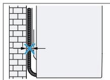
Ne coincez aucun tuyau entre le mur et l'appareil.
