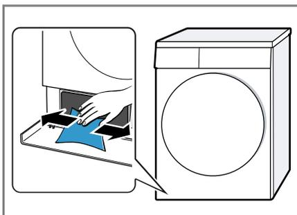
9. Insérez l'insert horizontalement jusqu'à ce que la patte s'enclenche.
