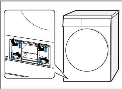
3. Retirez le couvercle de l'échangeur thermique par la poignée.
