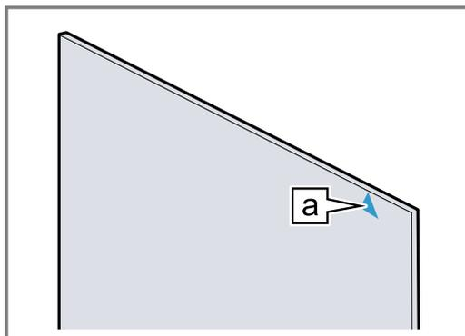
2. Introduire la vitre intermédiaire en bas dans la fixation [a] ① puis appuyer sur le haut en maintenant la pression.
