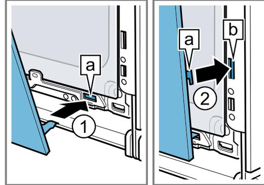
3. Presionar el cristal delantero por abajo ① hasta que se oiga que ha encajado.
