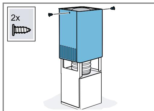
5. Posez sur l'appareil les deux pièces formant la partie inférieure du capot de cheminée et emboîtez-les ensemble.
