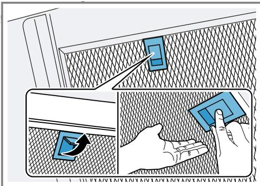
2. Retirez les filtres à graisse des fixations. Pour éviter l'égouttement de graisse, tenez les filtres à graisse à l'horizontale.
