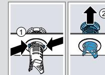
5. Unter fließendem Wasser die Siebelemente reinigen.
