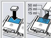
2. Den Deckel der Reinigerkammer schließen.
