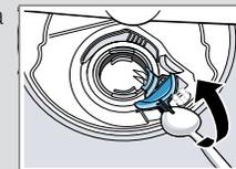
5. Levante a tampa da bomba de forma inclinada para dentro e retire.
