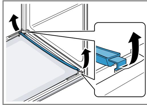
9. Si nécessaire, vous pouvez enlever la baguette de condensation pour le nettoyage.
