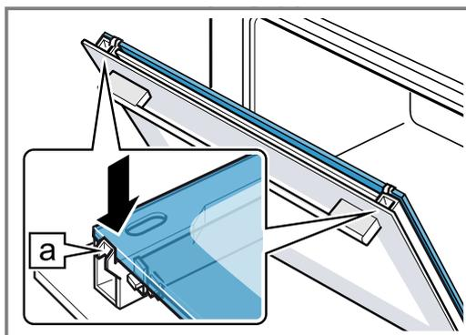
8. Poser le recouvrement de la porte ① et appuyer jusqu'à ce qu'il s'enclenche de manière audible.
