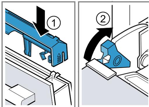
✓ Les leviers de verrouillage sont fermés. La porte de l'appareil est bloquée et ne peut pas être décrochée.
