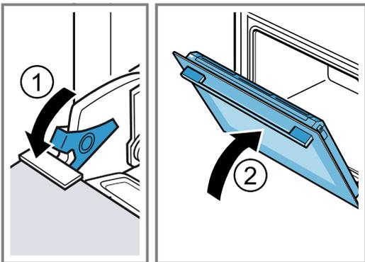
4. Appuyer sur le recouvrement de la porte à gauche et à droite à l'extérieur de la porte de l'appareil ① jusqu'à ce qu'il se débloque.
